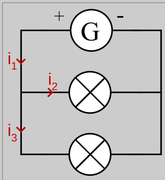
Dans le schéma ci-dessus, la loi des nœuds s'écrit :  $i_1 = i_2 + i_3$
