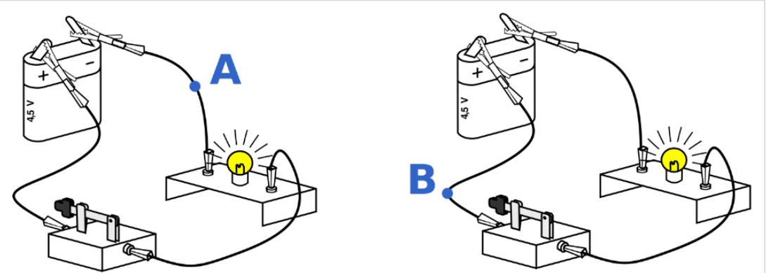
**1.** Sur votre cahier, tracer le schéma du circuit avec un ampèremètre pour mesurer le courant au point A.
