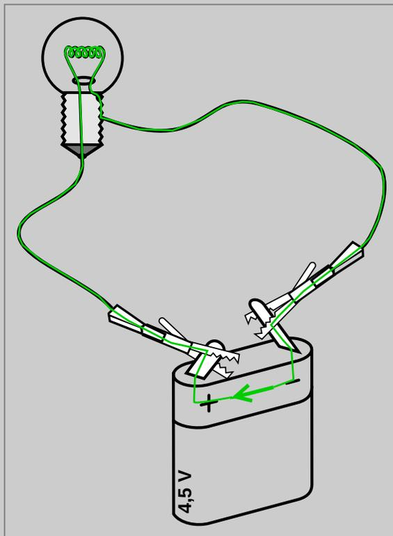
Le courant électrique a un sens. Par convention, à l'extérieur du générateur, **le courant électrique circule de la borne + vers la borne -**.
