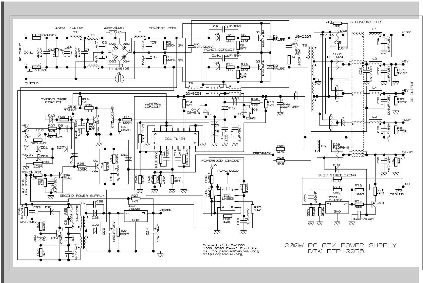
Un schéma normalisé est utilisé pour représenter un circuit électrique de manière lisible et simplifiée.
