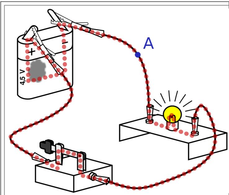
Le courant en un point, est le débit d'électrons en ce point du circuit.
