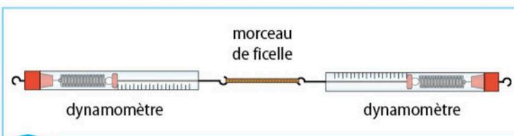
Fig. 1 Le dispositif expérimental
