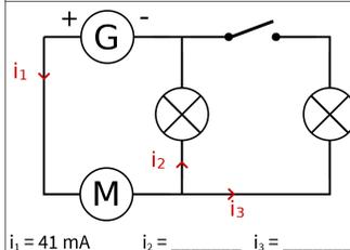
$i_1 = 41 \text{ mA}$   $i_2 = \dots$   $i_3 = \dots$
