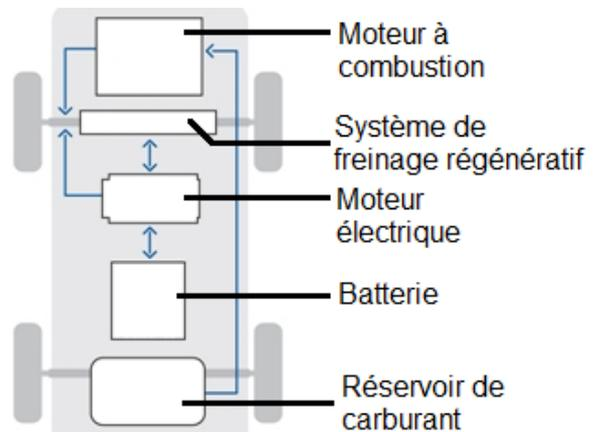
**Question 1** : identifier la source d'énergie utilisée par le moteur à combustion.
