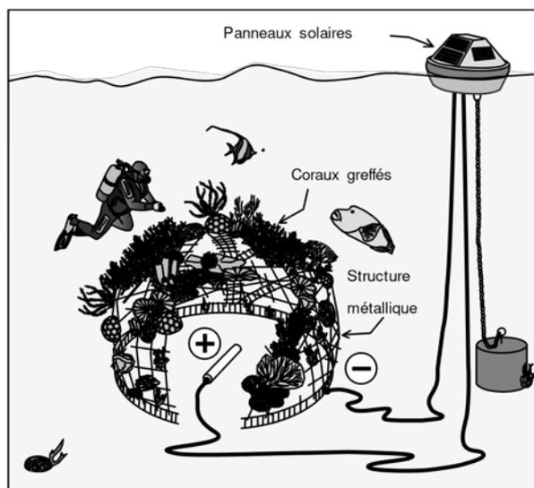
Cette structure métallique peut être alimentée par des éoliennes, des panneaux solaires, des turbines entraînées par les courants de marée ou encore des groupes électrogènes fonctionnant à l'huile de coco.
